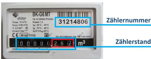
Den **Zählerstand** können Sie bei den gängigen Zählern (Eintarif- und Doppeltarifzähler) ganz einfach an einem mechanischen Rollen-Zählwerk ablesen. Dabei lesen Sie bitte grundsätzlich nur bis zur Kommastelle ab. Diese ist meistens mit einer roten Markierung oder auch einfach mit einem Komma gekennzeichnet. Bei den Stromzählern wird der Zählerstand in Kilowattstunden (kWh), bei Gas- und Wasserzählern in Kubikmetern (m<sup>3</sup>) angezeigt.
